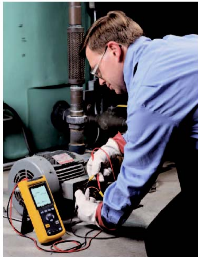
使用 Fluke 43B 电力质量分析仪来进行平均瓦特测量。
